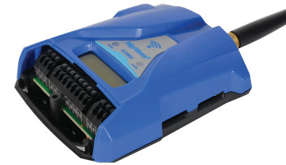
יחידת התראה סלולארית עם תצוגה דיגיטלית היחידה שולחת התראות SMS ואוספת נתונים עד 32G 2 כניסות - 4-20mA 4 כניסות דיגיטליות 2 יציאות מגע יבש מתח אספקה 12v סוללת גיבוי רגש טמפרטורה מובנה
