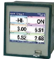
רשם ללא נייר עד 8 כניסות עבור 4-20mA , PT100 / PT1000 פרוטוקול תקשורת MODBUS RTU אגירת נתונים על DISK ON KEY תוכנה חנימית
